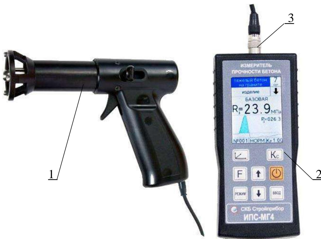
1 – преобразователь; 2 – электронный блок;
