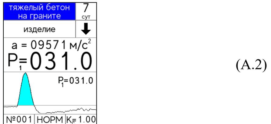
Для отображения параметров ударного импульса можно в процессе измерения прочности бетона нажать клавишу «↓».
