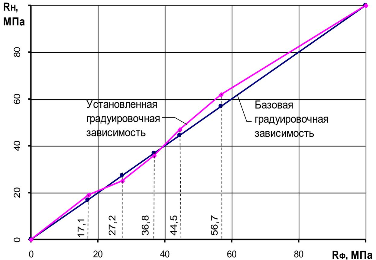
**Примечание** - Индивидуальная градуировочная зависимость может устанавливаться по данным параллельных испытаний одних и тех же участков методом отрыва со скалыванием и прибором ИПС-МГ4, при этом средняя квадратическая ошибка градуировочной зависимости  $S_T$ , в соответствии с методическими рекомендациями МДС 62-1.200 (ГУП НИИЖБ), определяется по формуле:
