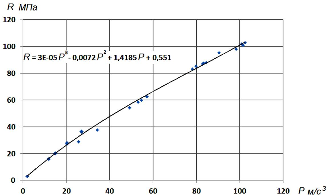
Рисунок 3 - Построение градуировочной зависимости между параметром  $P$  и прочностью бетона  $R$  с помощью полинома третьего порядка:  $a_3 = 0,00003$  (3E-5);  $a_2 = -0,0072$  (7,2E-3);  $a_1 = 1,4185$ ;  $a_0 = 0,551$
